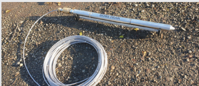
Зонд Boretrak2 с подсоединенным стальным тросом
